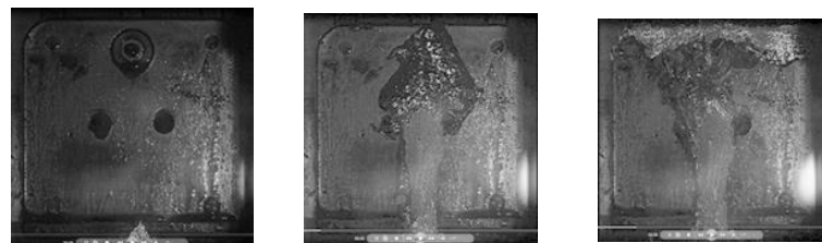
固相率40% (注湯温度605°C、ショットタイムラグ 5sec)
