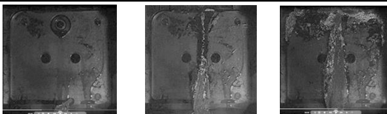
固相率20% (注湯温度605°C、ショットタイムラグ 0sec)
