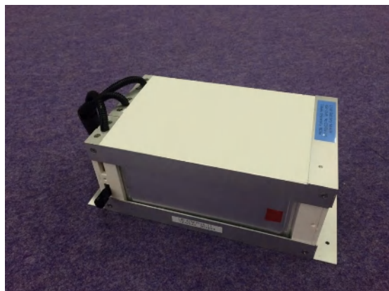
東北大学製 Liイオンバッテリー搭載 144V-25Ah 3.6kWh
