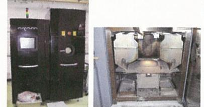
図 EBM本体外観写真(左)とチャンバー内部写真(右)
