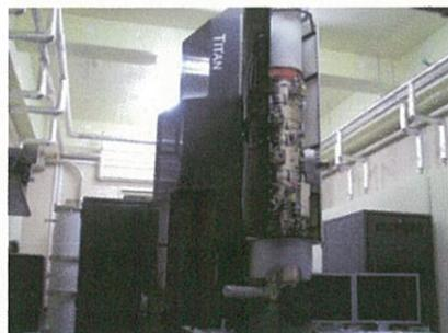
図4 収差補正機能を有する最新型の電子顕微鏡では0.1ナノメートルの原子間隔を観察できます。
