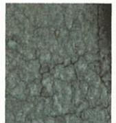
金型材の熱衝撃疲労割れの再現
