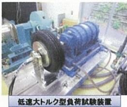
低速大トルク型負荷試験装置
