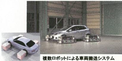
複数ロボットによる車両搬送システム
