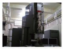
図4 収差補正機能を有する最新型の電子顕微鏡では 0.1ナノメートルの原子間隔を観察できます。
