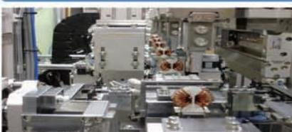
世界で唯一無二のトロイダルコイルの自動生産システムを開発し、
