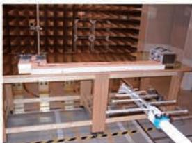
BCI試験 (最大印加電流: 300mA)
