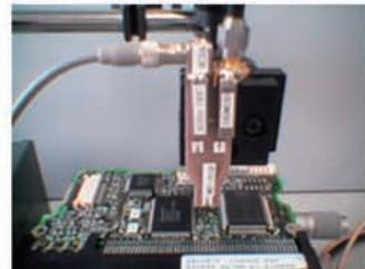
開発したMI効果型磁界プローブによる測定例
