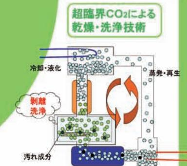
乾燥工程が不要、水も溶媒も仕様しない、微細構造物にも
