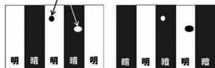
スリットを1周期分シフトさせながら複数枚の画像を撮影、輝度差の最大画像・最小画像を生成し、差分を取る。
