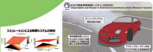
凍結路面等において、車両と路面との間に滑りが生じても、その滑りを利用して車両の運動を意のままに操ることを可能とする次世代高度車両制御システムの開発を行っています。
