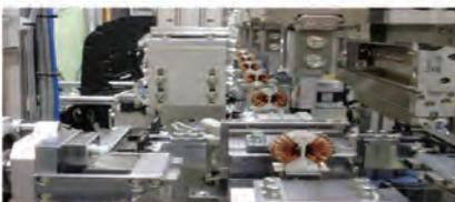
世界で唯一無二のトロイダルコイルの自動生産システムを開発し、山形県の三川事業所にて累計で2,000万個以上を生産しています。手作りと比較し、特性がより安定しており、エアコンをはじめ、さまざまな分野で使用されています。
