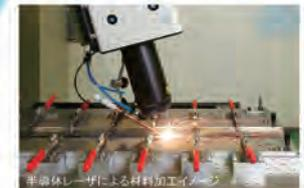
半導体レーザーによる材料加工イメージ
