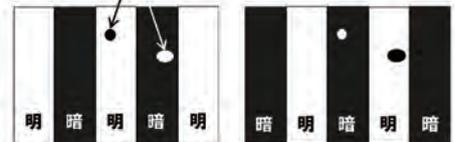
スリットを1周期分シフトさせながら複数枚の画像を撮影、輝度差の最大画像・最小画像を生成し、差分を取る。欠陥の部分のみ輝度差が変化することを利用。
