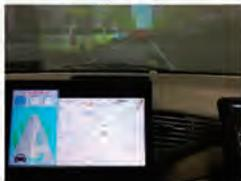
東日本大震災時に実際に取られた避難行動の一つである対向車線走行の有効性をドライビングシミュレータで検証
