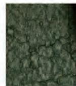
金型材の熱衝撃疲労割れの再現
