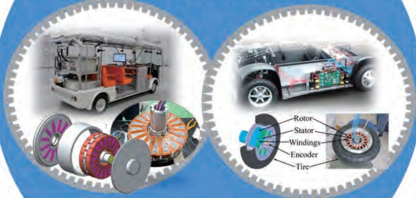
世界初のインホイールダイレクトドライブ SRモータEVの走行に成功！
