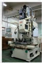
粉川研究室における摩擦攪拌接合機と超音波接合機
