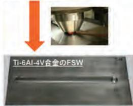
大きなツール損傷なし
