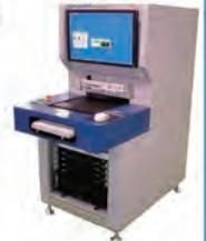
BGA・CSP検査装置
