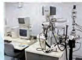
低歪速度破断機構付オージェ電子分光分析装置
