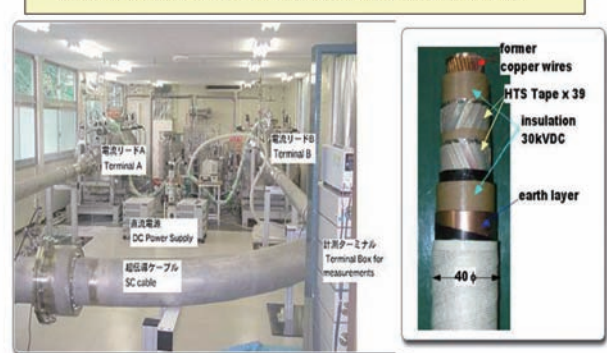
図3. 高温超伝導ケーブル(右:住友電工製)による直流送電システム研究施設(左:中部大学)
